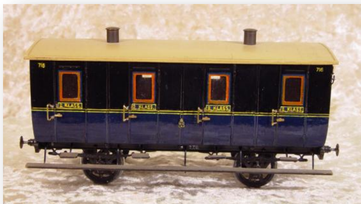
Litt B7 Nr 716 licenstillverkad av Alex. Keiller & Co i Göteborg (senare Götaverken). 9 st levererade, nr 709-717, år 1867. 32 sittande i 2:a klass. Vikt 7.5 ton och axelavstånd 3.66 m.
