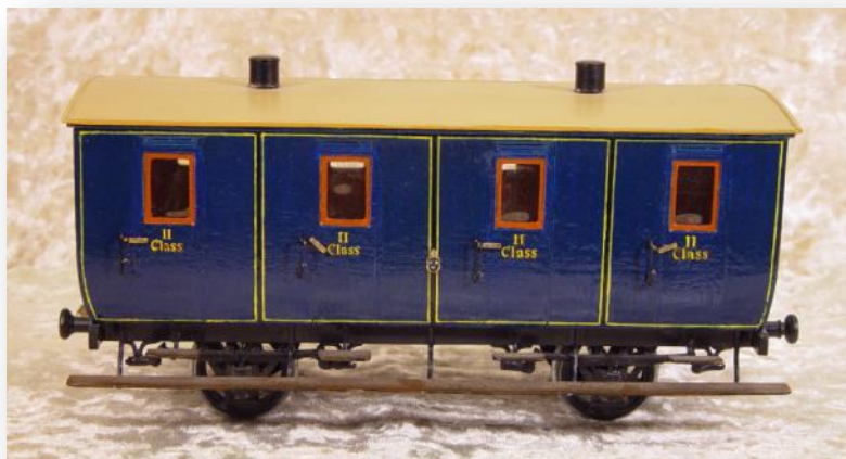
Litt B7 tillverkad av Lauenstein i Hamburg . 18 st levererade åren 1856 - 64. 32 sittande i 2:a klass:-Vikt 7.5 ton och axelavstånd 3.66 m.
