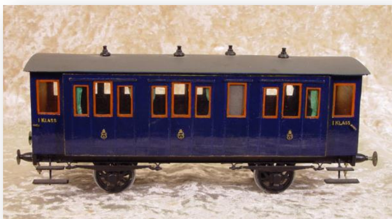
Litt A5 tillverkad av Actien-Gesellschaft für Fabrikation von Eisenbahnbedarf i Berlin. 12 st levererade år 1872. 18 sittplatser. Vikt 11 ton och axelavstånd 4.11 m. Gasbelysning.
