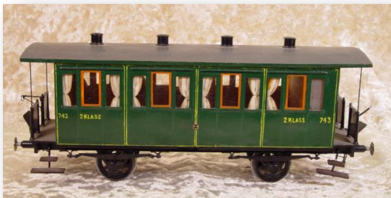
Litt B5 nr 743 tillverkad av Actien-Gesellschaft fur Fabrikation von Eisenbahnbedarf i Berlin. 10 st levererade år 1872. 21 sittplatser. Vikt 9.2 ton och axelavstånd 4.11 m. Gasbelysning.
