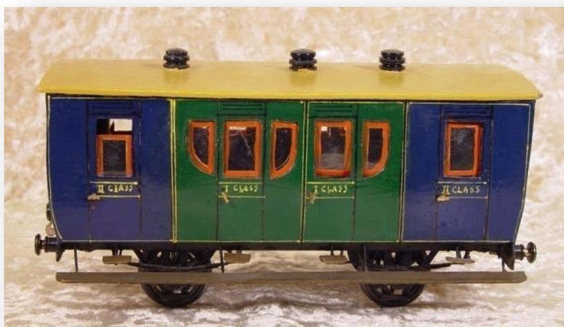
Litt AB6 tillverkad av Lauenstein'sche Wagen-Fabrik Gesellschaft i Hamburg. 8 sittplatser i 1:a klass och 16 i 2:a. 20 st levererade 1856-66. Vikt 7.8 ton och axelavstånd 3.66 m.
