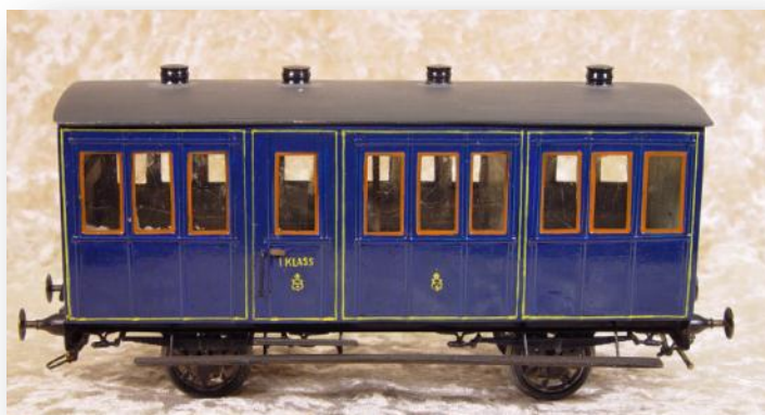
Litt A3 tillverkad av Actien-Gesellschaft Norddeutsche Fabrik für Eisenbahn-Betriebs-Material i Berlin. 34 st levererade år 1874. 14 sittplatser. Vikt 11 ton och axelavstånd 4.11 m. Gasbelysning.
